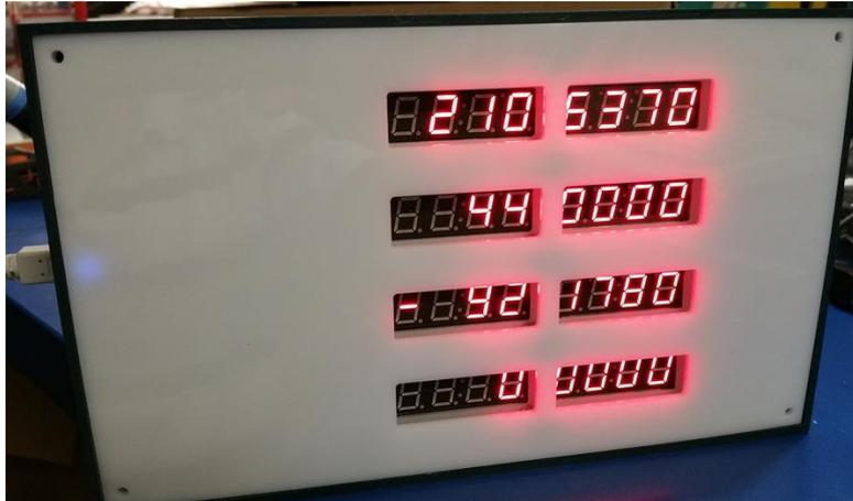
Mit Hilfe des Moduls „LED Panel 4 Achsen“ (Datei TFLEDPANEL\_JWMDL.dll“ im Ordner „Plugins“) kann eine digitale Anzeige für Achsen-Koordinaten mit 4 Vorkommastellen und 4 Nachkommastellen realisiert werden. Die DRO Anzeige kann mit jeder Steuersoftware funktionieren die eine Schnittstelle zum Rauslesen der Koordinaten bietet die über ein Plugin realisierbar ist - diesem Beispiel wird die Anbindung an Eding CNC beschrieben.
