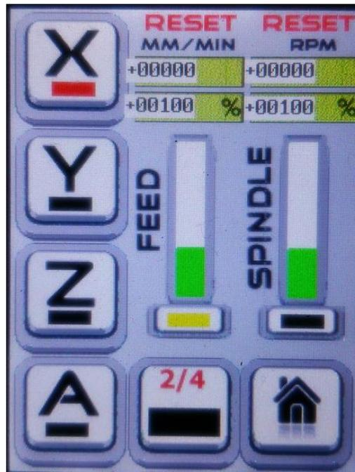
Das ist der spezialisierte Bildschirm für 2/4 Takt Modus. Von diesem Bildschirm aus kann man aber auch Override-Einstellungen für die Spindeldrehzahl und Feed verändern oder zurücksetzen. In dem Fall wenn keine der Tasten des Handrades gehalten wird – verändert sich der jeweils ausgewählte Override-Wert beim Drehen des Handrades.
