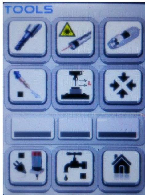
Auf diesem Bildschirm sind nicht alle Tasten mit Funktionen belegt. Sie können Sprühnebelkühlung, Flutkühlung und Spindel ein – und ausschalten. Andere Tasten können je nach Bedarf selber belegt werden. Der Zustand wird durch die LED's signalisiert.
