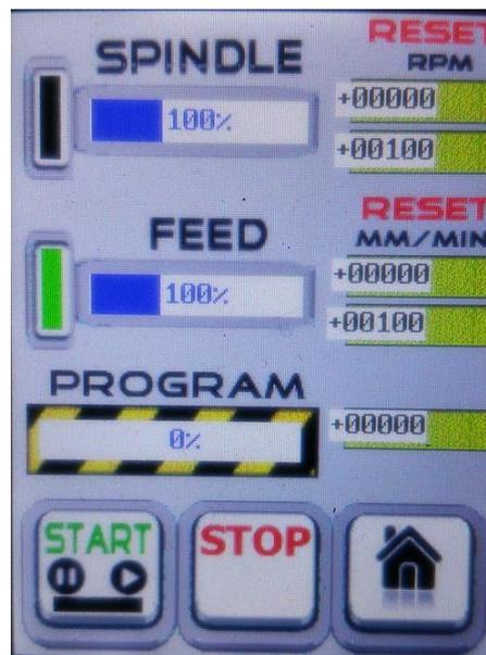
Dieser Bildschirm ist für die Programmausführung gedacht. Hier können Sie genauso wie in dem „2/4 Takt“ Bildschirm beim Drehen des Handrades die Override-Werte anpassen oder zurücksetzen. Zusätzlich wird hier der geschätzte Verlauf des Programms (in %) dargestellt.
