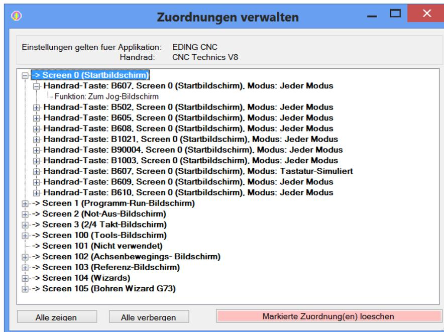
Hier am Beispiel des LCD Touch Pendant Handrades sieht man welche Funktionen welcher Taste auf welchem Bildschirm zugeordnet sind. Diese Zuordnungen kann man löschen (Klick auf „Markierte Zuordnung(en) loeschen“), verschieben oder eine neue Funktion hinzufügen (dies ist durch ein Kontextmenu möglich - Maus Linksklick -):
